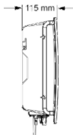
Inversor fotovoltaico RS 1.5-2.0 3.0 con entrada única MPPT (UoM: mm)
