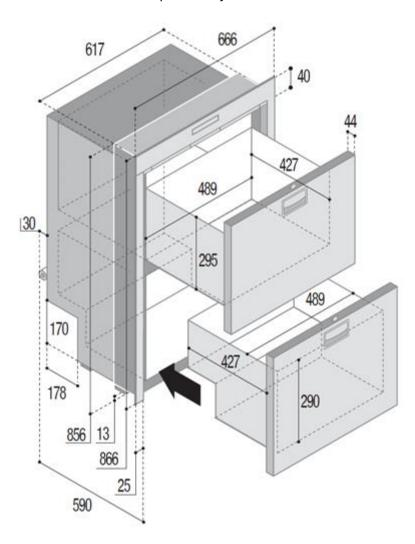
Dimensiones de empotrado con perfiles de fijación Door Inside - Door Outside
