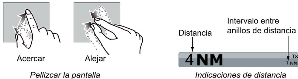
Para la unidad TZTBB, también puede controlar la distancia durante el funcionamiento como se explica a continuación. Toque el cuadro de escala del radar de la esquina inferior izquierda de la pantalla para que se muestre la barra deslizante. Arrastre el icono de círculo para ajustar la escala de distancia.
