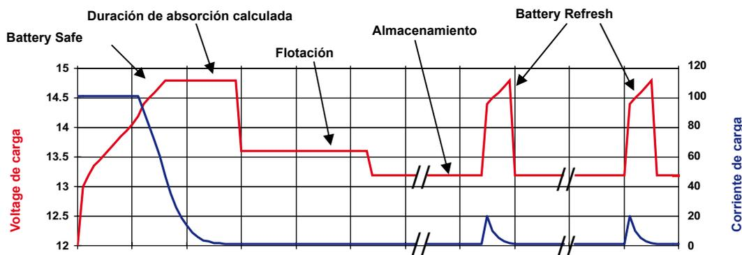
Fig. 4: Carga adaptable en 4 etapas de Victron
